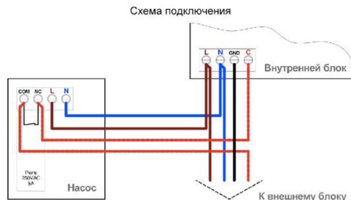
Данная схема подключения аварийного выхода является одним из примеров его использования, допускается подключение другими способами.
